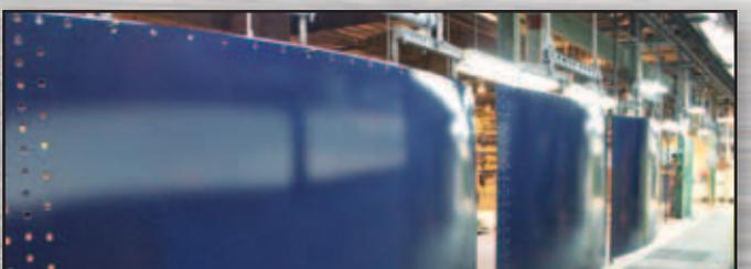
**Stufe 4:** Glass-fused-to-Steel Platten werden qualitätsgeprüft und für den Versand vorbereitet
