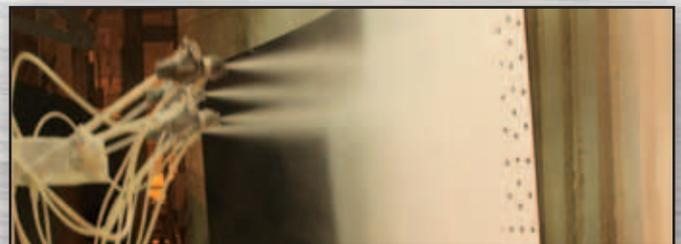
**Stufe 2:** Platten werden mit Vitrium Glasbeschichtung beschichtet
