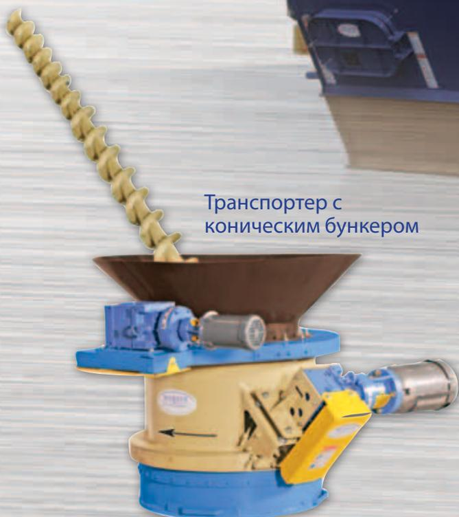
Силосный транспортер с тангенциальным приводом
